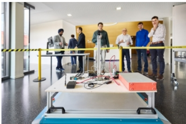
R3 Solutions et Götting ont mis au point un système combinant un scanner et une caméra embarqués qui communique via un réseau DECT NR +.
